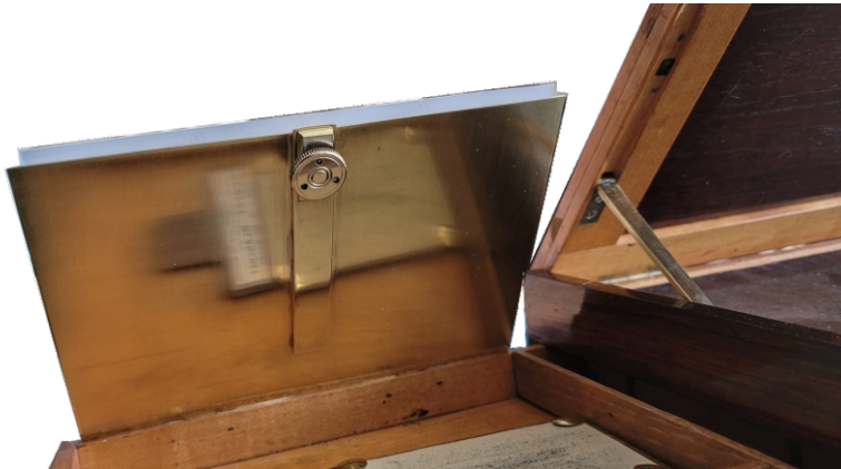
Détail de la plaque support de la feuille modèle vue de l'arrière. On voit le profilé qui peut accueillir le système d'extension du support.
